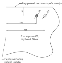
Сверление отверстий под верхние стопора-ограничители
